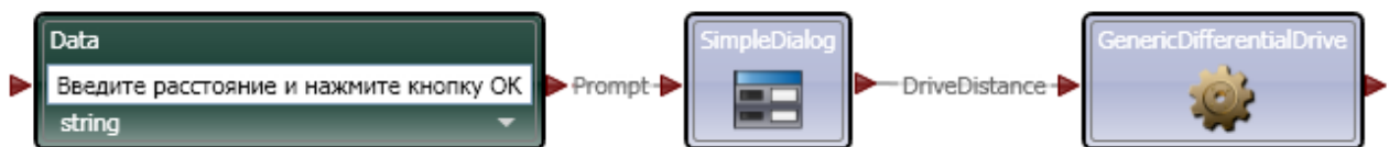
Рис. 1. Схема приведения робота в движение на заданное расстояние по прямой линии
